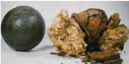
Balas de cañón de hierro fundido del siglo XVI, una de las cuales fue tratada mientras que la otra fue dejada al aire libre. F. GOALEC © UNESCO. ARCHEOLYSE INTERNATIONAL.
