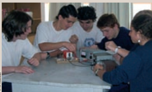
Dans le laboratoire de l'école, des élèves de l'Institut uruguayen Ariel Hebreo utilisent un ampèremètre et un voltmètre pour observer les changements d'intensité et de voltage dans un simple circuit de courant continu
